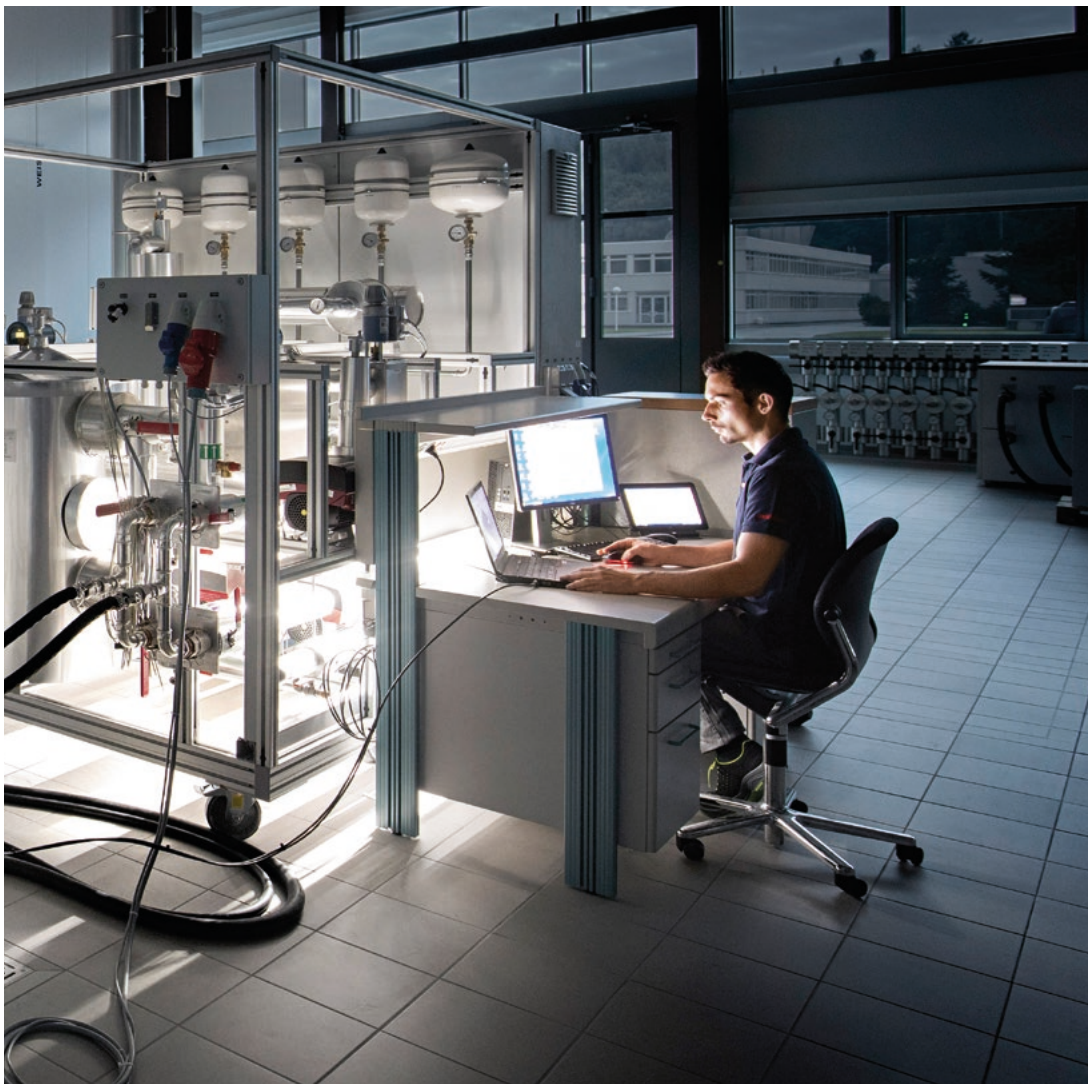
Prüfstand für Wärmepumpen mit Klimakammer
