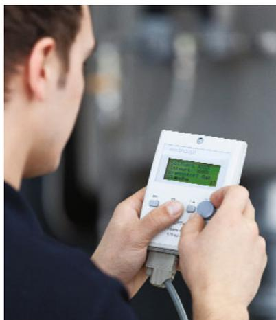
Ajuste mediante el terminal de usuario
